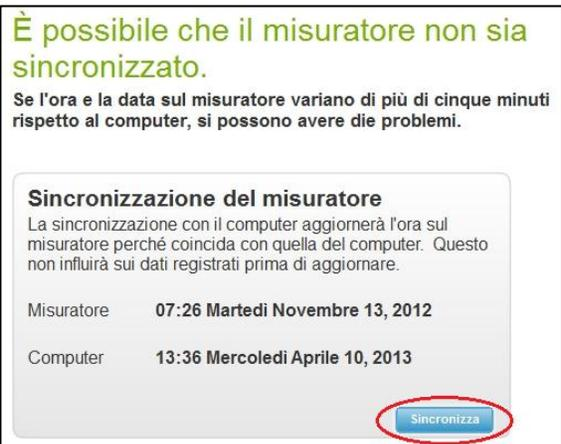
Se sul computer viene visualizzata la schermata "Sincronizzazione del misuratore", **fare clic su "Sincronizza"** per aggiornare l'ora sul misuratore. Al termine, verrà visualizzata la seguente schermata.
